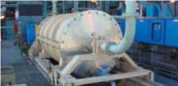
Figura 1: El M3000 IsaMill instalado en Lonmin, Sudáfrica.
