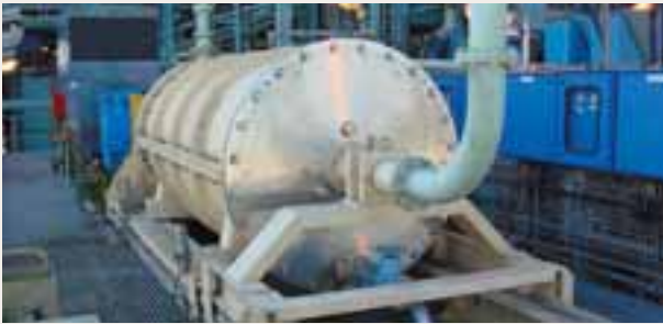
Figura 1: El M3000 IsaMill instalado en Lonmin, Sudáfrica.
