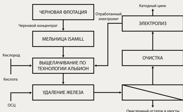
Рисунок 3: Принципиальная схема Технологии Альбион для прямого выщелачивания цинковых концентратов
