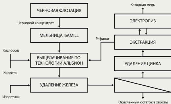
Рисунок 3: Принципиальная схема Технологии Альбион для переработки концентратов, богатых по меди и бедных по цинку
