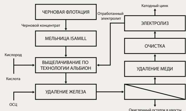
Рисунок 2: Принципиальная схема Технологии Альбион для переработки концентратов, богатых по цинку и бедных по меди
