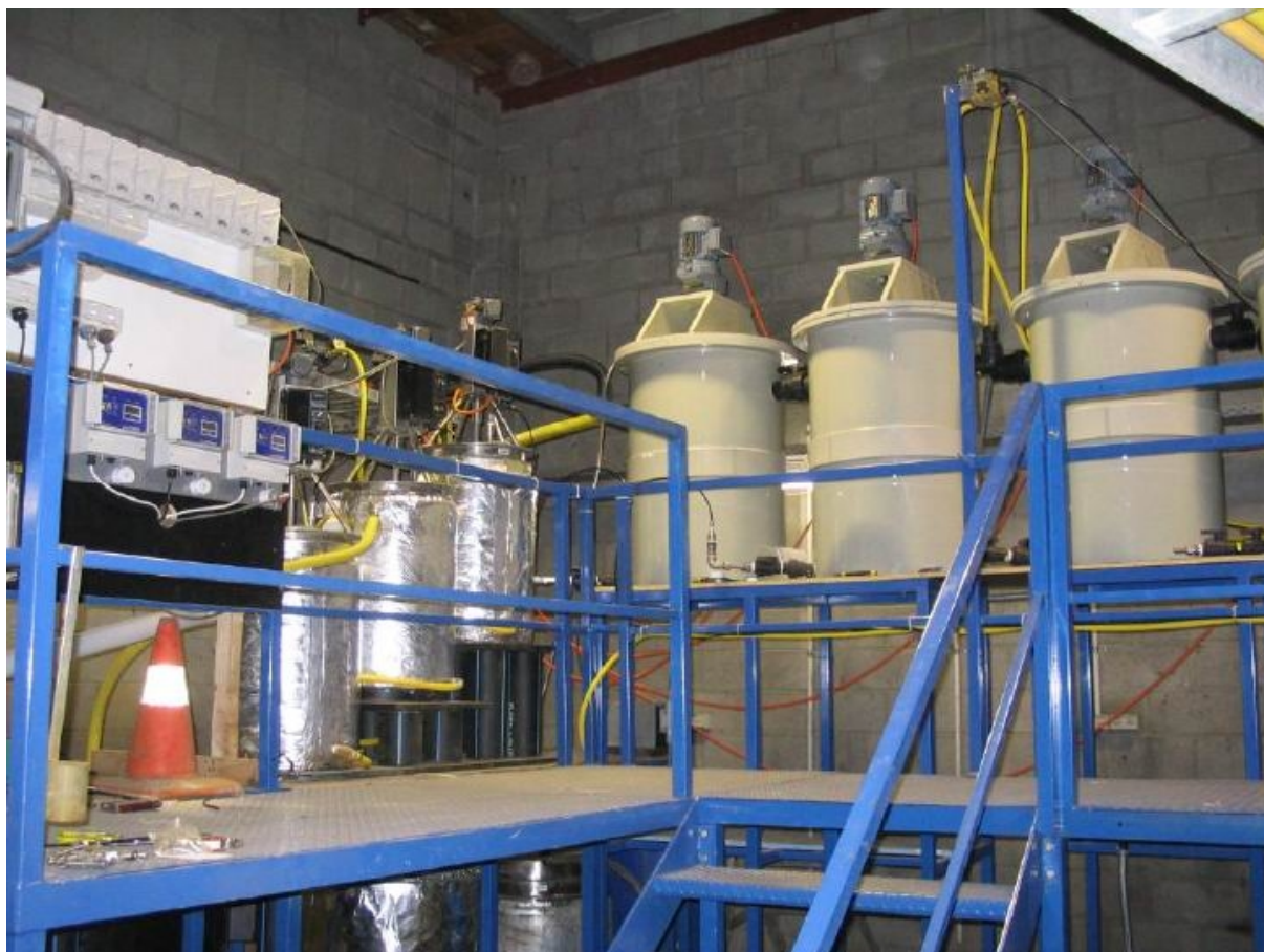
Рисунок 3. Чаны выщелачивания пилотной фабрики 3.3 ЭКСПЛУАТАЦИЯ ПИЛОТНОЙ ФАБРИКИ
